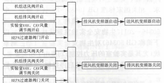
图2 启停顺序的控制流程图
