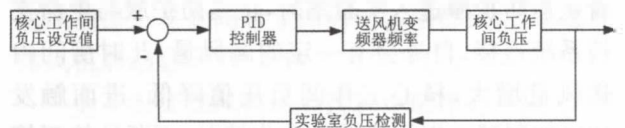
图 5 送风机变频器 PID 控制原理图
